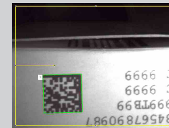
制药包装盒上的读码 包装盒上的ECC200码或者EAN 13条码可以同时读取，使用物体检测器还能检测光学字符的有无。
