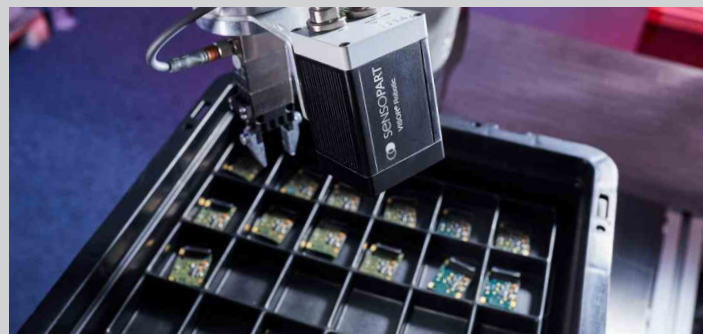
VISOR® Robotic 定位普通托盘中的零部件，然后实现稳定抓取。多达255种配置方案极大的方便了生产的多样性需求。
